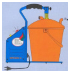
Slika 1. Shema uređaja za proizvodnju aktivnog hlora - hipohlorita iz slane vode (HIPOGEN)
